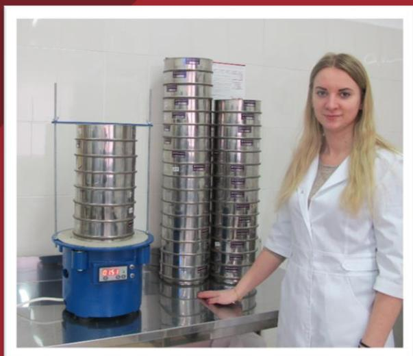
Рассев лабораторный РЛ –1, сита лабораторные для зерна и муки
