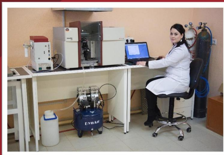
Атомно-абсорбционный спектрофотометр NovAA 350
